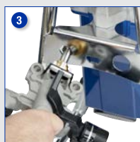
Brug det sekskantede hul i rammen til at løsne pumpen og fjern pumpedelen
