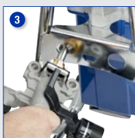
Brug rammeseksantfittingen til at løsne farvesektionen og afmontere pumpen
